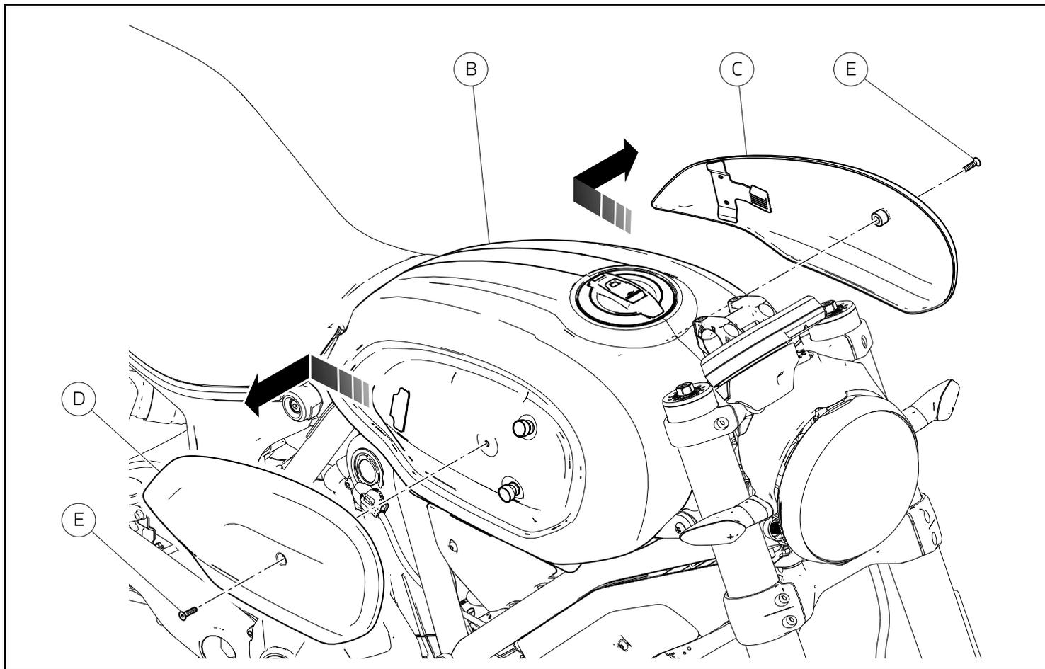
En agissant des deux côtés du motorcycle, desserrer les 2 vis (E) fixant les caches droit (D) et gauche (C) au réservoir (B). Déposer le cache réservoir droit (D) en le poussant vers l'arrière du motorcycle et en le tirant ensuite vers l'extérieur.
